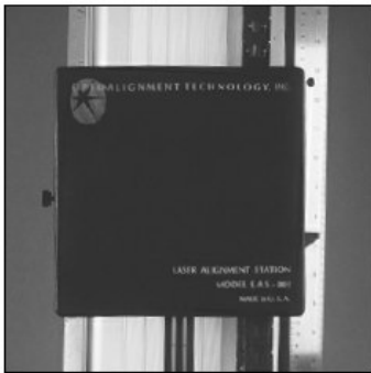
La tête de mesure comprend une diode laser et une camera CCD
