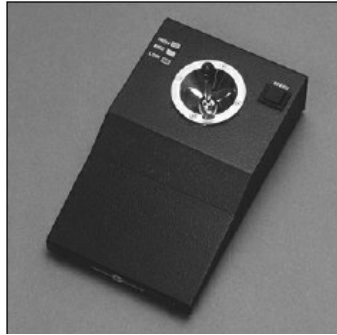
La manette de contrôle comporte 3 vitesses de déplacement et permet le positionnement rapide de la tête de mesure
