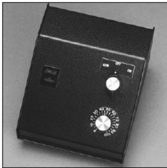
Le plateau à coussin d'air motorisé peut tourner à une vitesse comprise entre 1 et 20 tours par minute.
